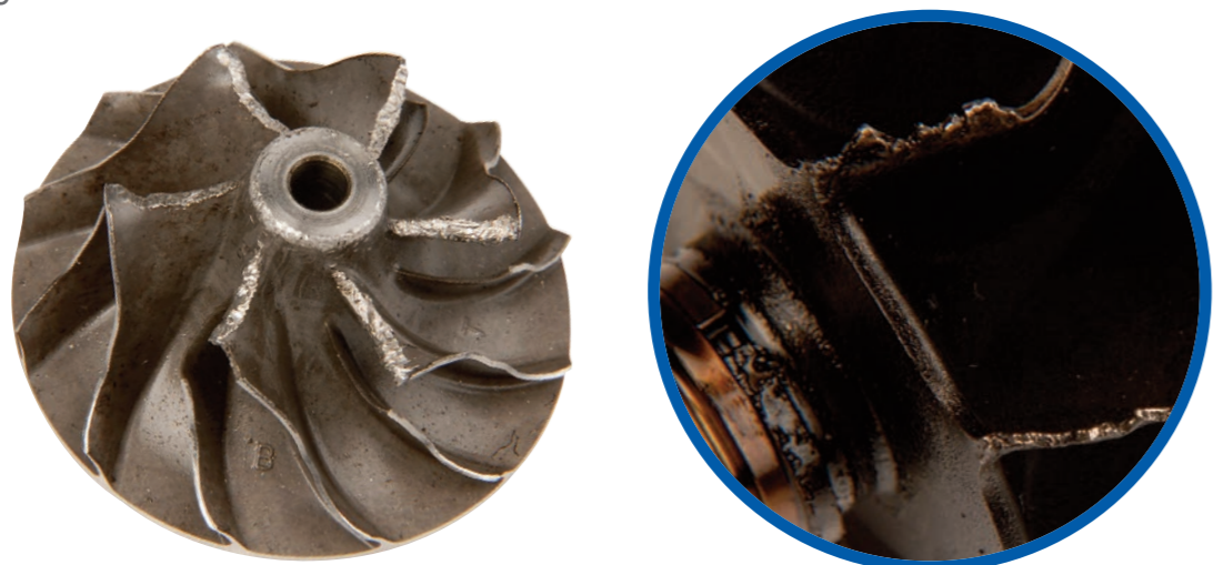
Danni all'induttore della girante turbina o della girante compressore
