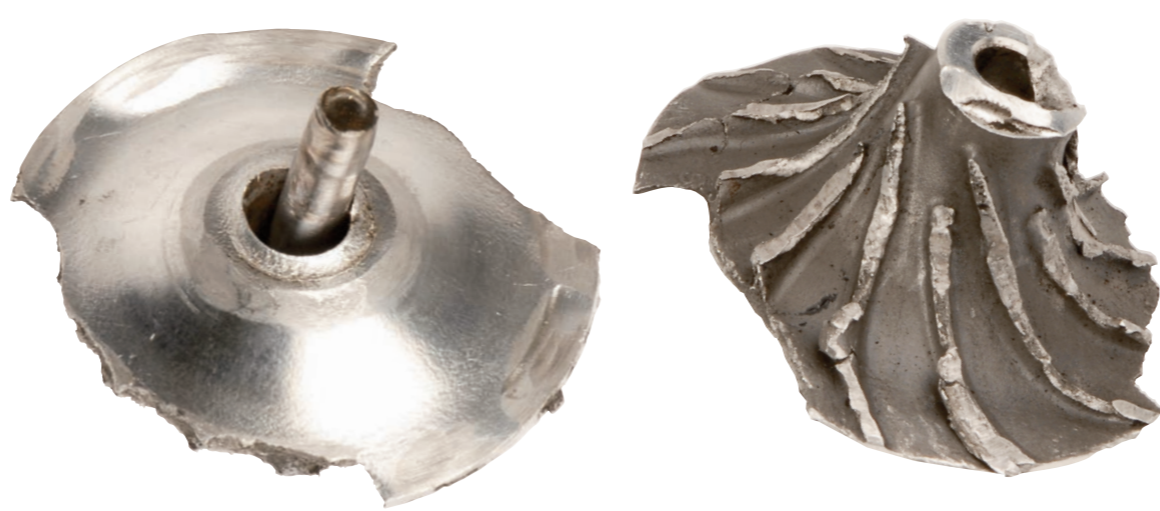
Rottura totale del componente
